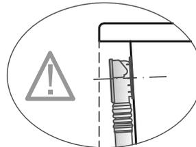
Bei der Installation folgender **Ab-/Über- und Zulaufgarnitur** ist aufgrund der überstehenden Bauteilgeometrie eine lotgerechte Verfließung **nicht** möglich.
