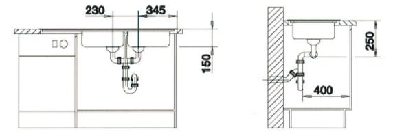
Représentation avec système d'écoulement 137034 et siphon 217839
