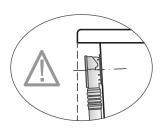
Bei der Installation folgender **Ab-/Über- und Zulaufgarnitur** ist aufgrund der überstehenden Bauteilgeometrie eine lotgerechte Verfliesung <u>nicht</u> möglich.
