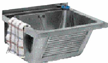
RVS wandwastrog zonder kraanwerkbank met wandoverloop. De voorzijde van de wastrog is voorzien van horizontale ribbels. Ophangbeugels zijn vast aan de wastrog verbonden. Geleverd met afvoerplug met stop en ketting 1 1/2". De schroeven en pluggen voor de wandmontage worden bijgeleverd.
